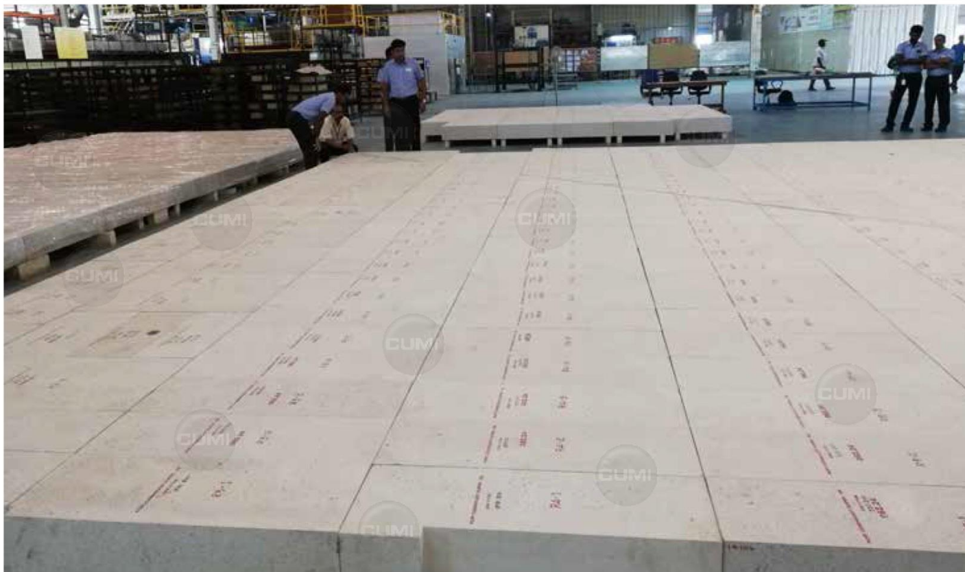
Нижние блоки печи для плавки флотат-стекла из шамотной глины - CUMILOX 45GB / PCPF CUMIHICAST SUPER
