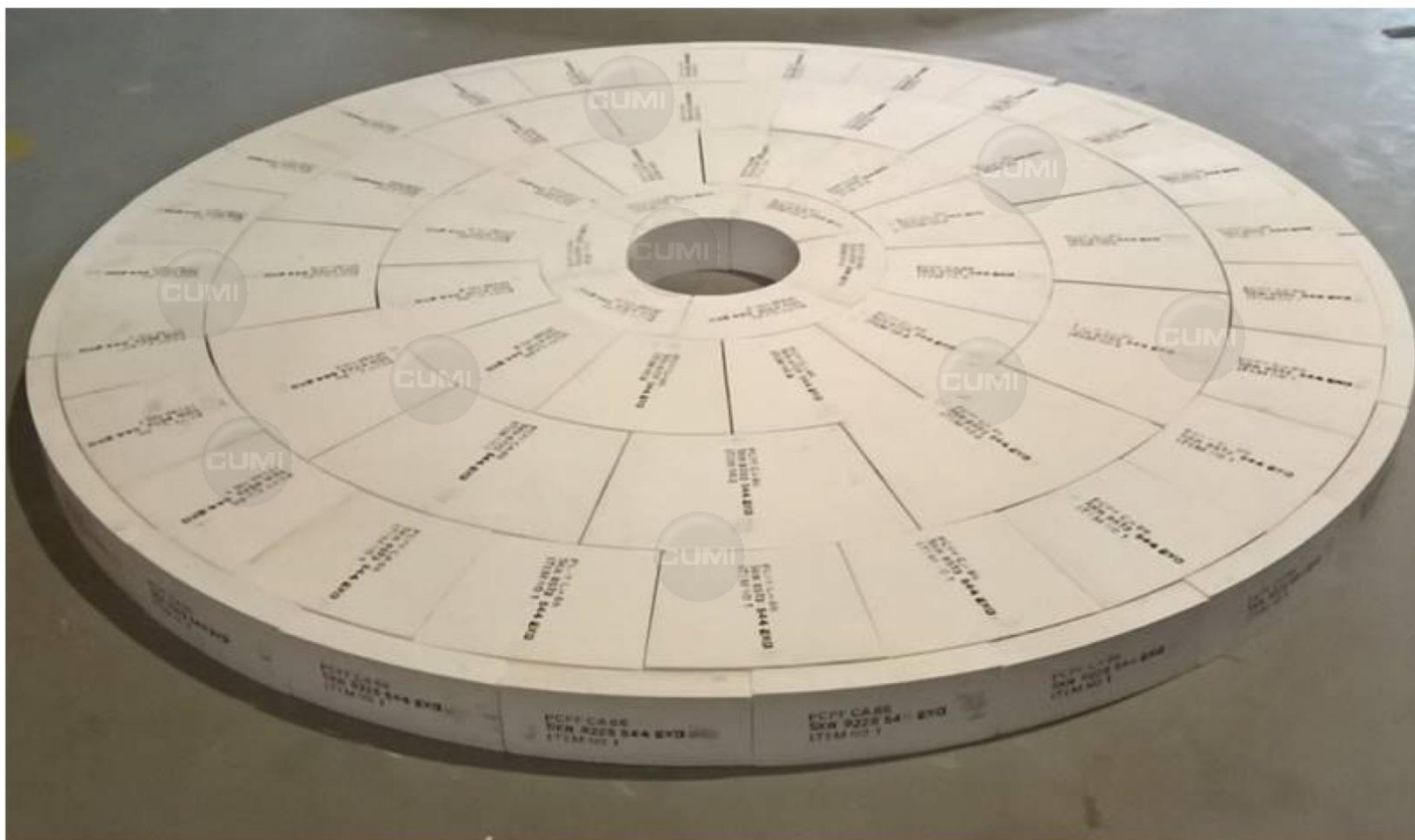
Нижние блоки варочной части печи из 94% глинозема для стекловолокна - PCPF CUMICRETE CA66
