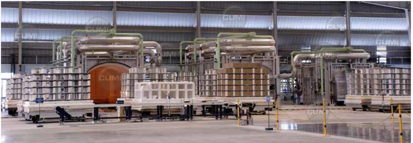
Печи периодического действия с рабочей температурой до 1750°C
