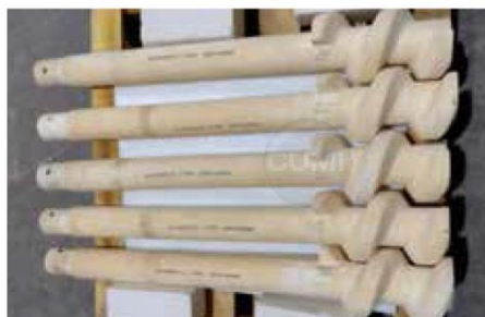
Мешалки из циркониевого муллита - GLASSFLO 11ZR
